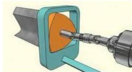
Broca com forma de triângulo de Reuleaux para fazer furos "quadrados" (o eixo é flexível devido ao fato de que não há um centro em posição fixa)
